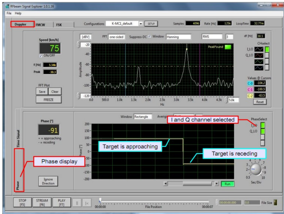
图 12. 通过通道 I 和通道 Q 的相位关系来判别运动方向
