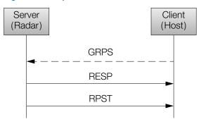
Figure 25: Set parameter structure
